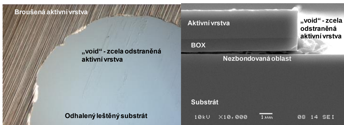
Obr. 6 Ukázka typického defektu – „void“ – „díry“ v broušené aktivní vrstvě SOI (tloušťka vrstvy 8 \mu\text{m} , rozměr díry \approx 3 \text{ mm} ). Příčinou defektu je nezbondovaná oblast. Ukázka SEM detailu leštěné SOI struktury na pravém panelu. Pod vrstvou BOX je patrná nezbondovaná oblast, která přechází v úplnou díru – odpadlou část aktivní oblasti (před bondingem byla oxidována aktivní deska).
