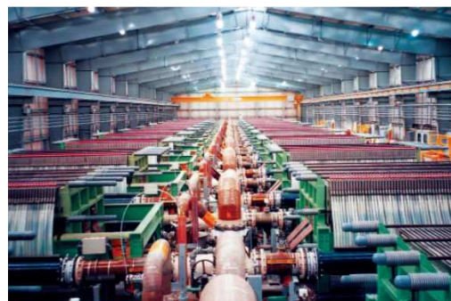
Hala s membránovými elektrolyzéry (Bayer)
