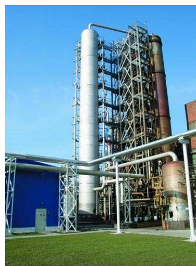
Absorpční věž výroby HNO 3 (BC MCHZ Ostrava)
