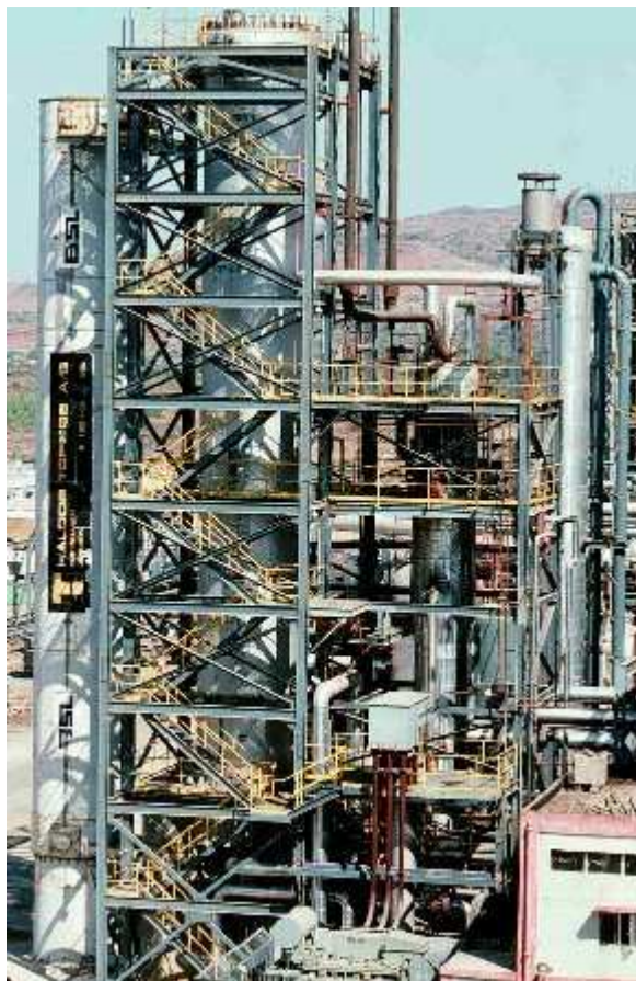
Reaktor produkující 1500 t \text{NH}_3 /den. Obsahuje 250 t (100 m 3 ) katalyzátoru
