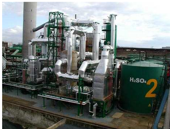
Pro výrobu \text{H}_2\text{SO}_4 jsou charakteristická mohutná izolovaná potrubí pro plynné proudy. Mezi nimi je věž pro oxidaci \text{SO}_2 . Obsahuje náplň křemelinových tablet, pokrytých \text{V}_2\text{O}_5 . Další věž je absorpční kolona. (Precheza Přerov)
